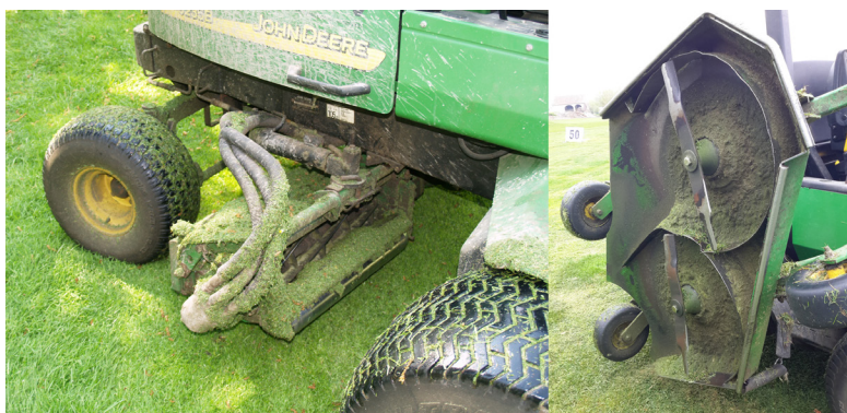
5.19 Contrariamente agli apparati di taglio a lama elicoidale, in quelli a lama rotante non si può intervenire su erba bagnata perché i residui imbrattano l'interno del piatto e ingolfano lo scarico dell'erba rendendo impossibile la prosecuzione del lavoro
