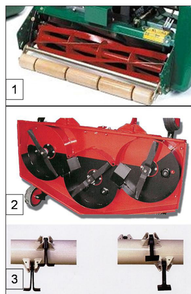
5.12 Tipologie di apparati di taglio: 1) lama elicoidale; 2) lama orizzontale; 3) flagelli
