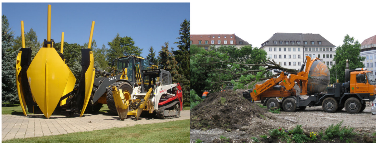
3.9 Modelli di estirpatrici-trapiantatrici per i "grandi trapianti"
