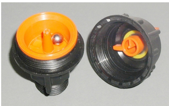
7.5 Irrigatore dinamico rotativo aperto: la sfera d'acciaio mossa da getti d'acqua interni fa ruotare il bocaglio
