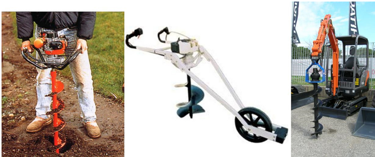
2.19 Tipologie di trivelle: manuale (a sx); con ruotino di sostegno (al centro); sulla testata di un miniescavatore (a dx)
