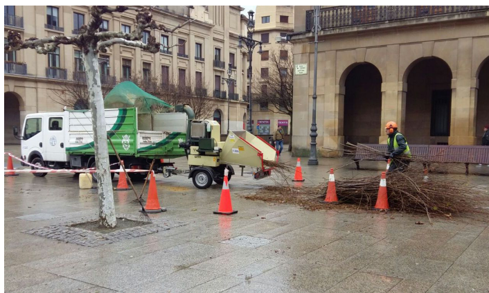
9.6 Smaltimento dei residui di potatura tramite cippatura in loco
