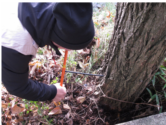
8.4 Estrazione di una carotina di legno mediante succhiello di Pressler
