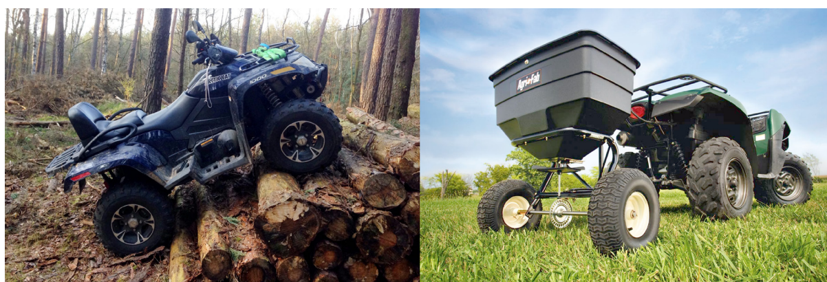
1.10 All-terrain vehicle di derivazione motociclistica, noti anche come quad. A destra uno equipaggiato con spandiconcime.
