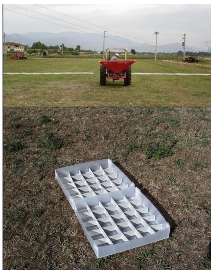
6.4 Controllo in campo della distribuzione trasversale di uno spandiconcime. In basso, le scatole a misura standardizzata che si impiegano nelle prove
