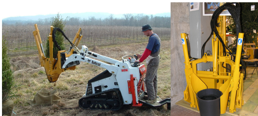
3.8 Estirpatrici-trapiantatrici di piccole dimensioni, principalmente adatte al lavoro in vivaio
