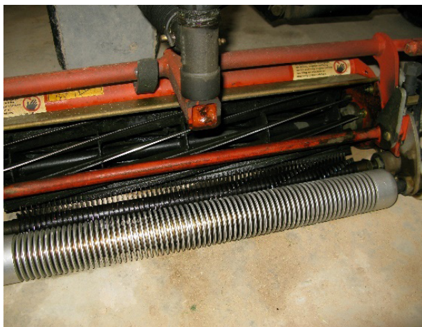
5.14 Particolare del rullo scanalato e del groomer montati anteriormente alla lama elicoidale
