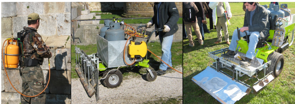
6.15 Attrezzature di diverse dimensioni per il diserbo localizzato in ambito urbano messe a punto dall'Università di Pisa
