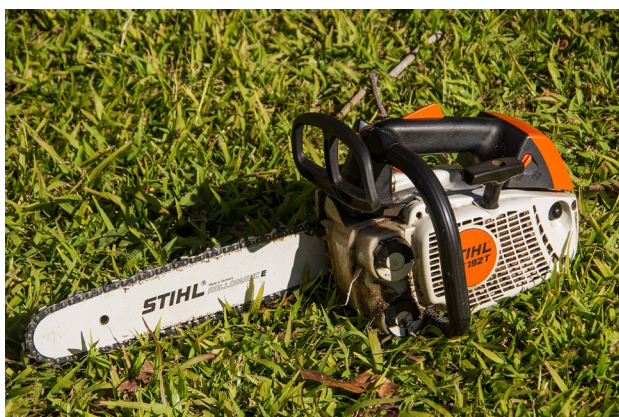
8.22 Motosega leggera per potatura: si può notare la caratteristica dell'impugnatura superiore che ne permette l'utilizzo con una sola mano
