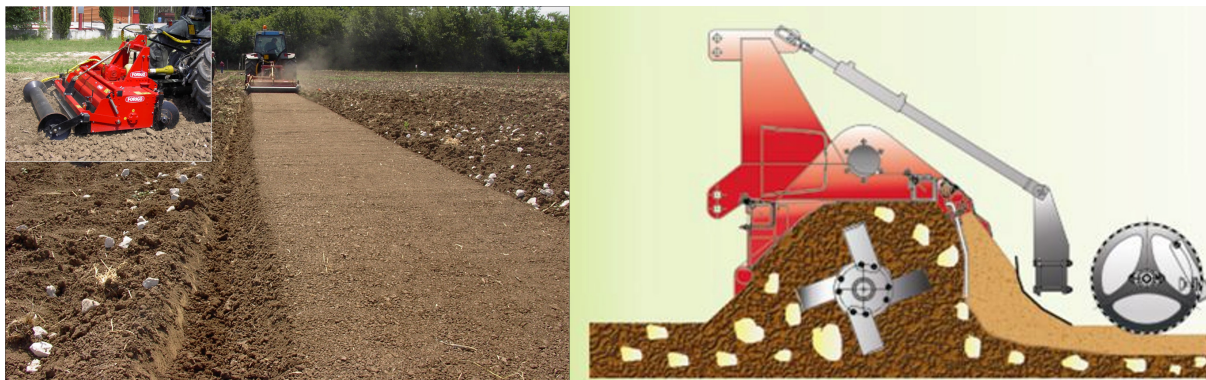
2.3 Zappatrice interrassassi, sua utilizzazione in campo e schema di funzionamento
