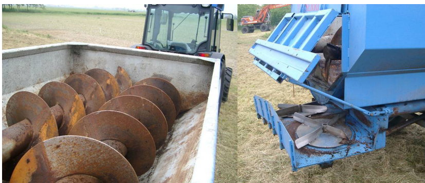
6.5 Particolare del sistema di alimentazione (a coclee) e di distribuzione (a piatti posteriori) di uno spandicompost
