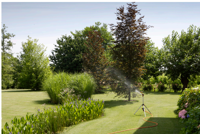
7.2 Il treppiede è una soluzione di basso costo e facile installazione ma richiede la presenza di una persona per gli spostamenti nel prato da irrigare
