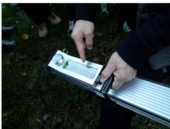
8.8 Il tracciato della resistenza all'avanzamento dell'ago consente di valutare le variazioni di densità del legno
