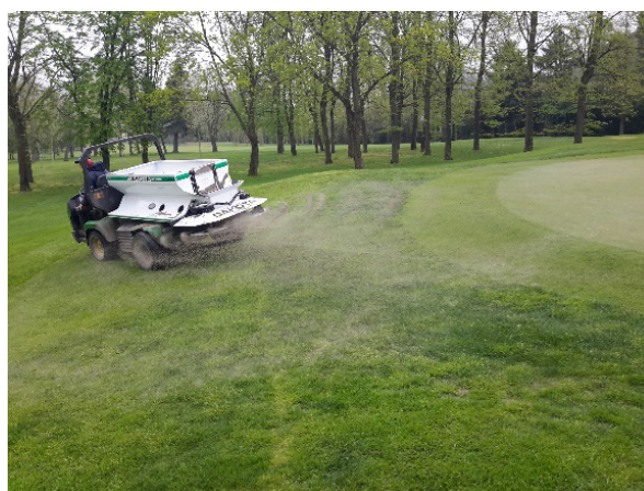
5.40 Top-dressing in un green con macchina a distribuzione centrifuga
