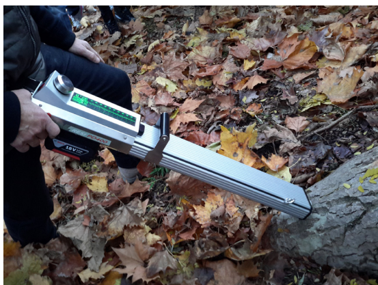
8.7 Le sonde penetrometriche o dendropenetrometri consentono di misurare la resistenza meccanica del legno
