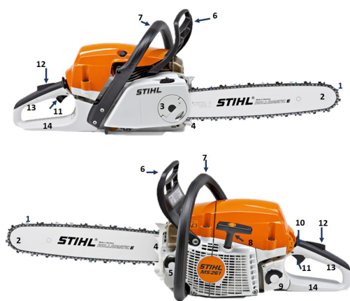
8.26 Parti della motosega. (1) Catena di taglio; (2) spranga di guida; (3) tendicatena rapido - con alette; (4) artigli; (5) tappo serbatoio olio; (6) protezione anteriore della mano; (7) impugnatura anteriore; (8) impugnatura d'avviamento; (9) tappo serbatoio carburante; (10) leva marcia/arresto; (11) grilletto di accelerazione; (12) bloccaggio grilletto; (13) impugnatura posteriore; (14) scudo posteriore di protezione della mano
