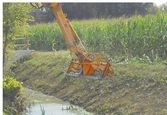
4.11 La benna è formata da barre di ferro ricurve che lasciano passare l'acqua trattenendo la vegetazione sfalciata dalla barra falciante
