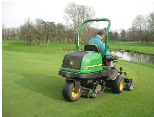
5.15 Tripletta da green con cilindri da 11 lame per un'altezza di taglio da 3 mm
