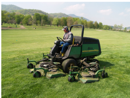
5.18 Un rider con lame rotanti orizzontali da rough e pre-rough: queste macchine sono adatte per altezze di taglio superiori a 3-4 cm
