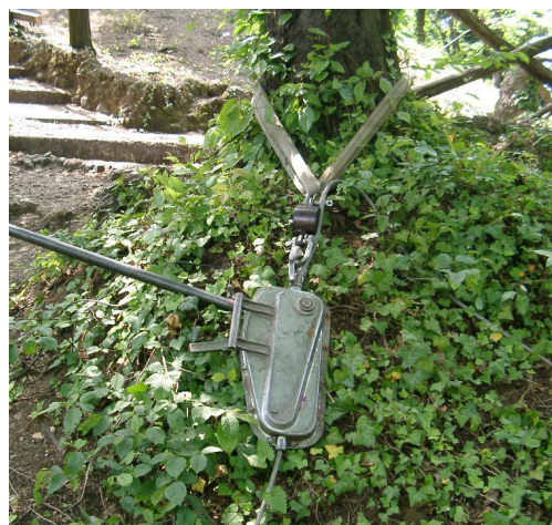
8.11 Verricello manuale per la prova di trazione dell'albero, fissato alla base di un albero adiacente a quello da controllare
