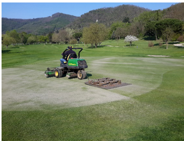
5.39 Dopo il top-dressing si può effettuare un passaggio con un tappeto per favorire la penetrazione della sabbia nei fori effettuati dalla precedente bucatura
