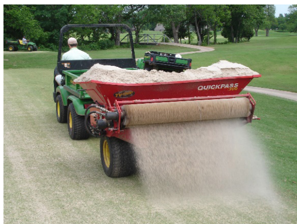
5.37 Distribuzione per gravità di materiale sabbioso per top-dressing
