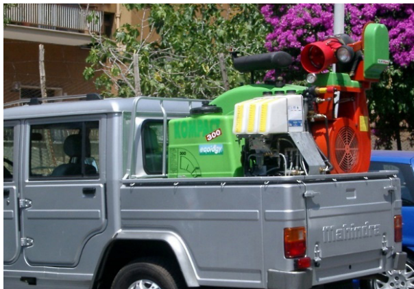
6.8 Gruppo irroratore con testata a cannone montato su pick-up
