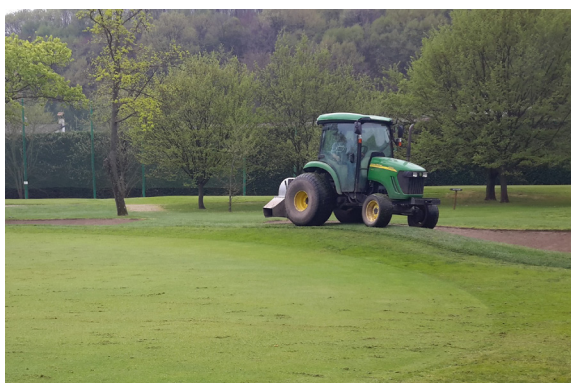
9.2 Intervento di soffiatura del residuo dopo un verticutting su un green
