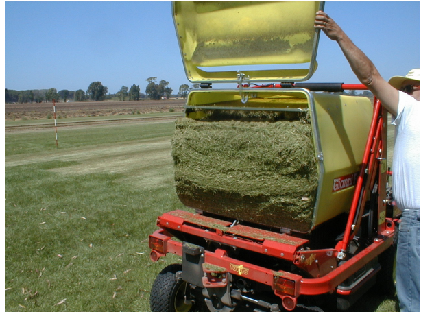
5.10 Particolare del cassone di carico dell'erba tagliata
