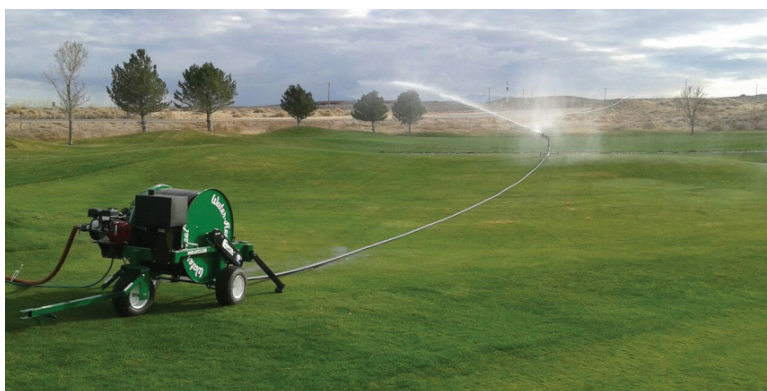
7.3 Per l'irrigazione delle aree verdi si utilizzano normalmente modelli di rotoloni di piccole dimensioni con torretta fissa
