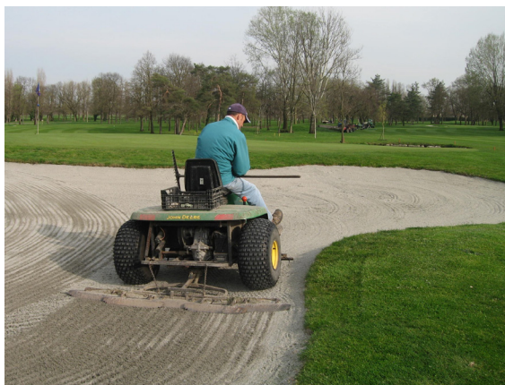
2.17 Rastrellatura di un bunker con apposita semovente con telaio triciclo a raggio di sterzata ridotto che agevola le manovre
