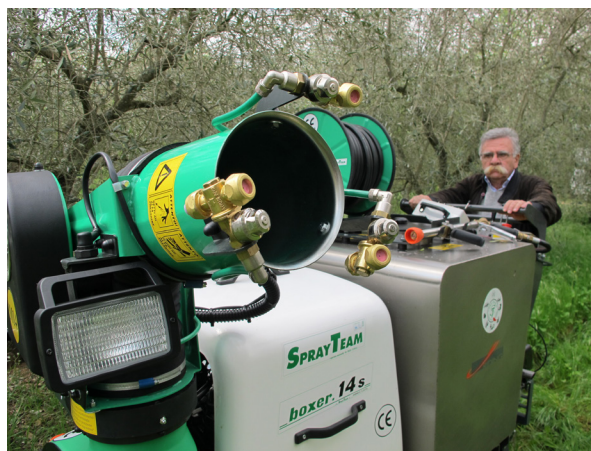
6.9 Piccolo atomizzatore a cannone con conducente a terra o con possibilità di essere telecomandato
