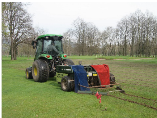
5.27 Carotatura eseguita su un fairway: le carote di terra vengono messe in andana per favorire la successiva raccolta
