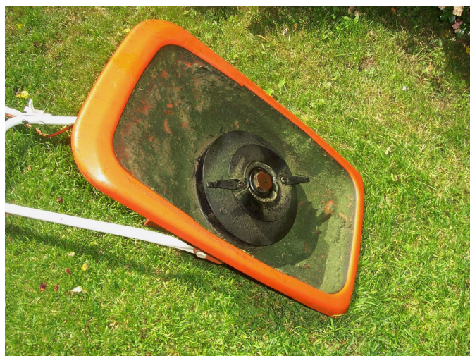
5.7 Rasaerba a cuscino d'aria con in evidenza la ventola che gli permette di operare sospeso
