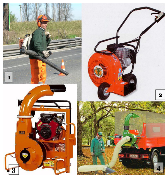
9.3 Tipologie di aspiratori e soffiatori. (1) a spalla; (2) con conducente a terra; (3) portato da trattore; (4) su autocarro con cassone-raccoglitore
