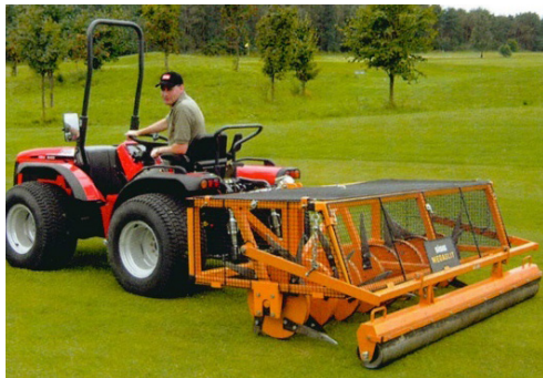
5.33 Attrezzatura con lame per incisioni fino a 20 cm di profondità
