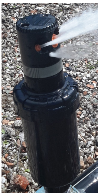
7.11 Per migliorare l'uniformità di distribuzione dei pop-up a lunga gittata sono presenti più boccali nella stessa torretta
