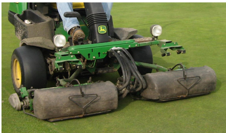
5.20 Piccoli cesti per la raccolta dell'erba tagliata da apparati a lama elicoidale
