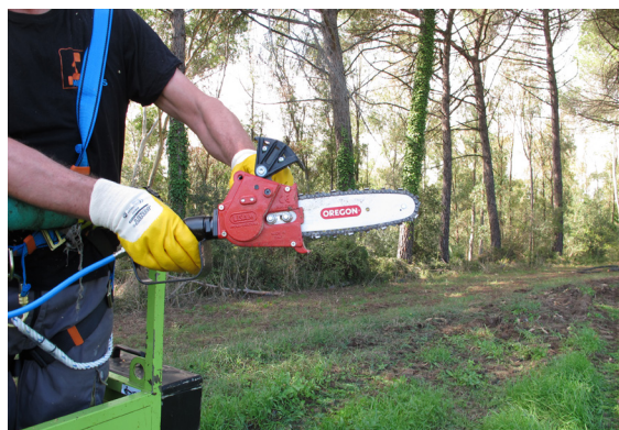
8.31 Seghetto pneumatico montato su piattaforma elevabile
