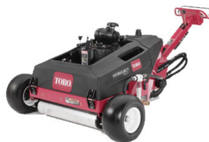
5.32 Macchina decompattatrice tramite iniezione di getti d'acqua a pressione
