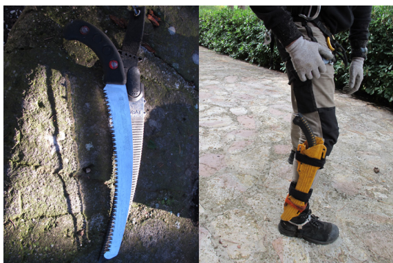
8.18 Segaccio fisso ad arco e posizionamento della custodia di un operatore di tree-climbing
