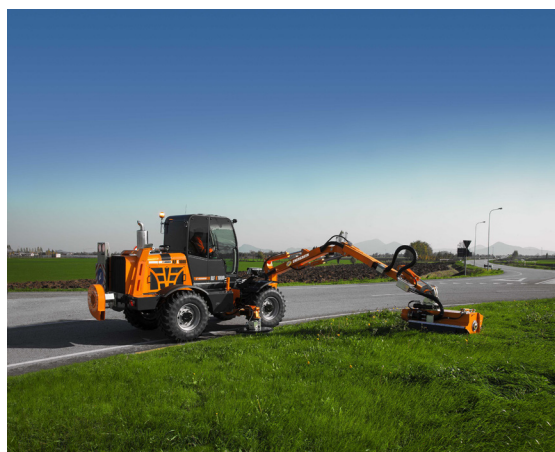
4.4 Trinciatrice idraulica su braccio articolato montato anteriormente al portattrezzi
