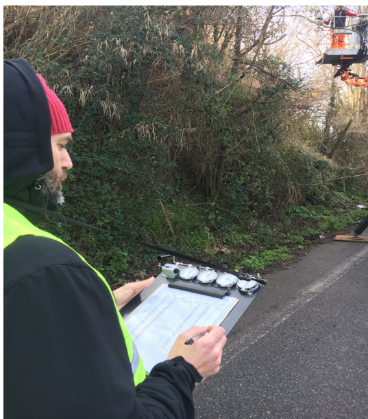
1.1 Rilievi dei tempi di lavoro mediante tabella a quattro cronometri centesimali e un contatore di eventi.
