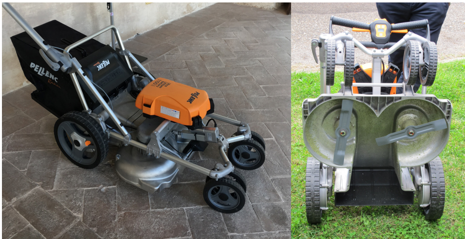
5.8 Rasaerba ad alimentazione elettrica a batteria, con lame orizzontali
