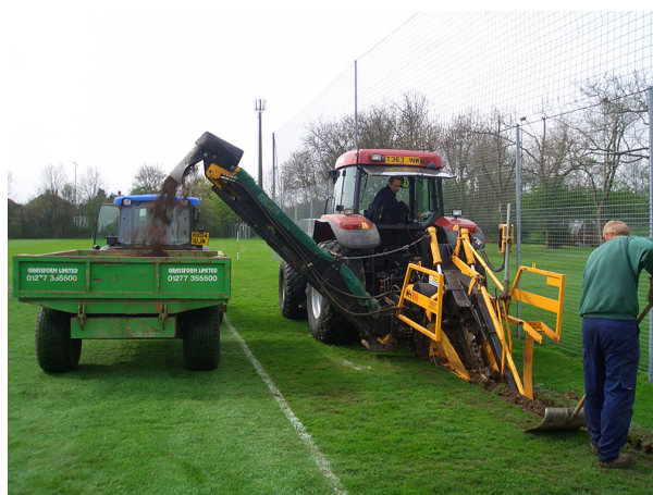
2.8 Escavatore a catena portato da trattore garden al lavoro in un campo da calcio
