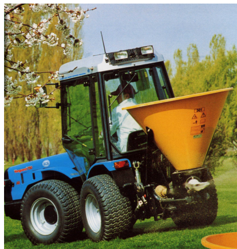
6.2 Spandiconcime centrifugo a braccio oscillante portato da trattorino tipo garden
