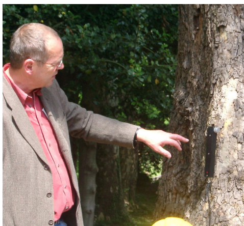
8.12 Collocazione di un elastomero durante una dimostrazione del metodo SIM da parte del Dr. Wessolly
