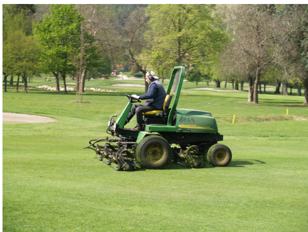
5.3 Il grasscycling non prevede la raccolta dell'erba tagliata ma il suo rilascio sul prato dopo una più o meno intensa triturazione. Nella foto una quintupla elicoidale sta effettuando un taglio con grasscycling in un fairway
