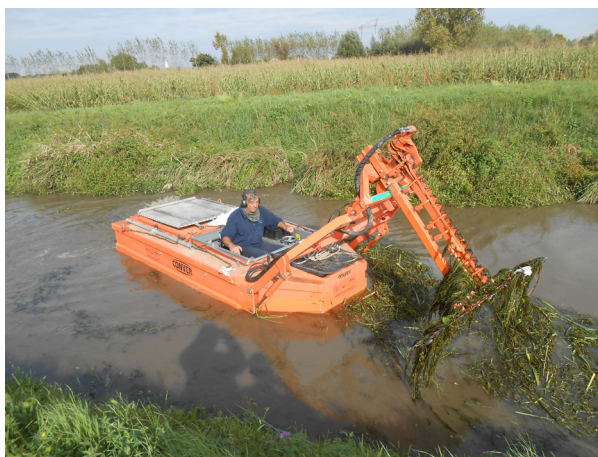
4.9 La motobarca falciante permette di falciare dentro l'alveo la vegetazione acquatica del fondo e delle sponde dei corsi d'acqua
