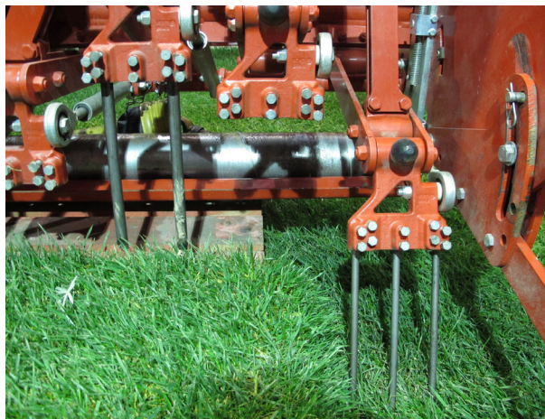
5.31 Fustelle piene di diversa grandezza adatte a bucatura e forconatura
