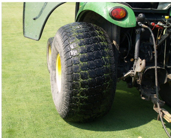
1.7 Gli pneumatici tipo garden o turf tyre (qui montati su un tractor garden ) sono indicati per le superfici dei tappeti erbosi
