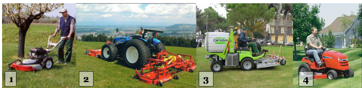
5.6 Classificazione di macchine rasaerba: 1) conducente a terra; 2) apparati di taglio portati da trattore; 3) semovente ride-on tipo "rider"; 4) semovente ride-on tipo "lawn-tractor"
