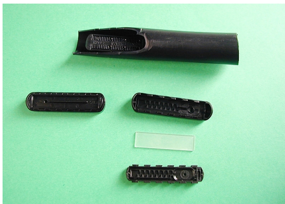
7.18 Sezione di ala gocciolante integrale con gocciolatore autocompensante: si può notare la membrana trasparente in silicone che, inserita all'interno del gocciolatore, consente di mantenere la portata in uscita uniforme anche se varia la pressione
