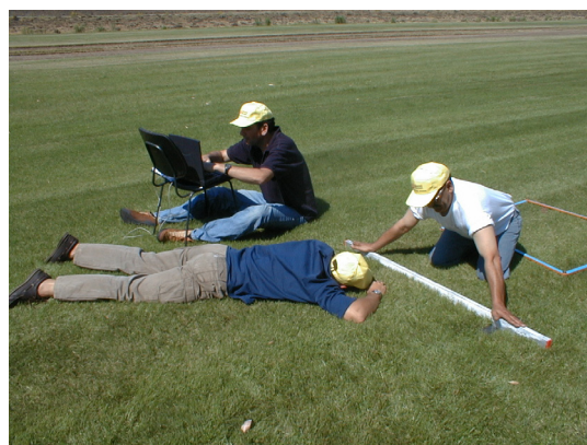
5.1 Determinazione dell'altezza del taglio dell'erba durante la certificazione di un rasaserba
