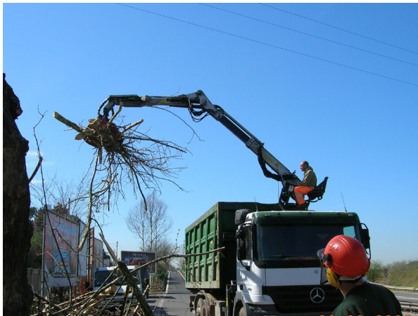
9.4 Caricamento delle ramaglie su autocarro con braccio telescopico con caricatore a ragno
