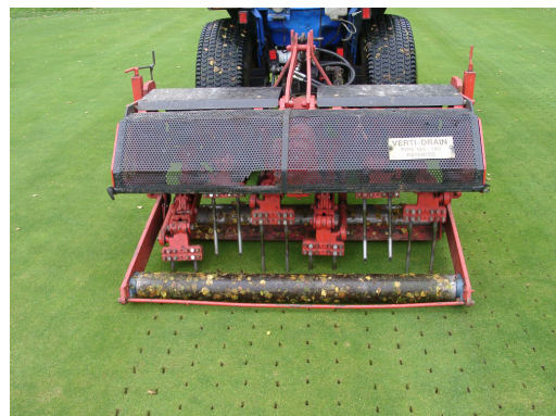
5.29 La forconatura viene eseguita da una bucatrice con alberi a gomito
