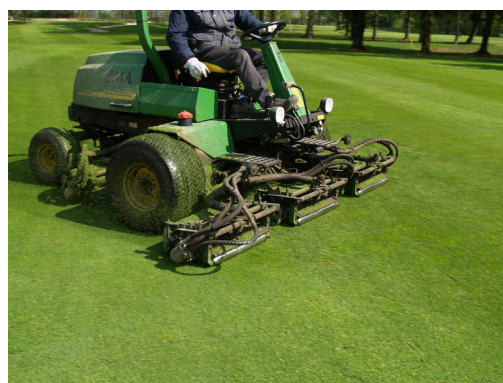
5.17 Rider a cinque cilindri con lame elicoidali per un taglio di qualità dell'erba nei fairway
