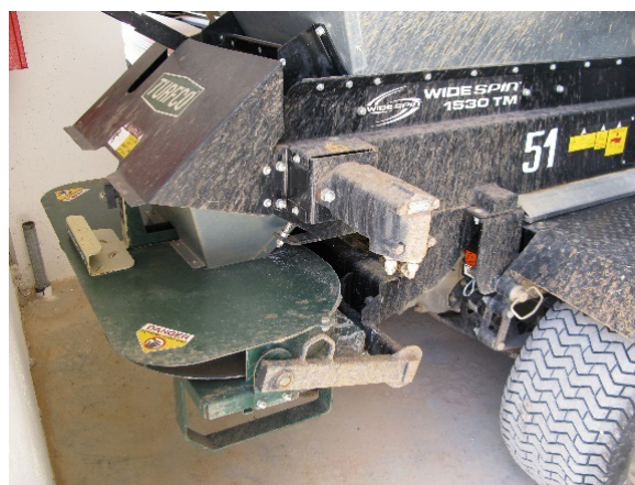
5.38 Particolare dell'apparato distributore centrifugo di una macchina per top-dressing
