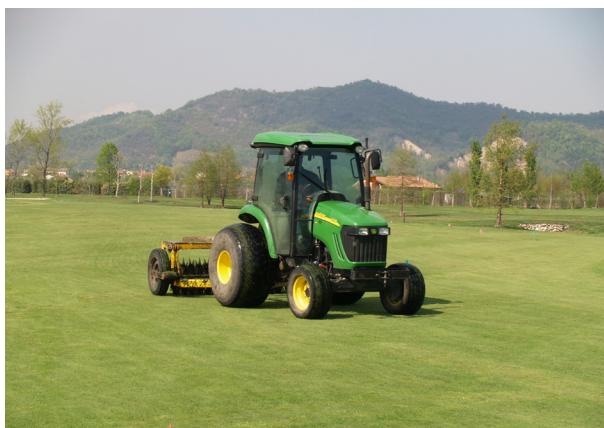
1.5 Compact tractor mentre effettua lo slicing nel fairway di un campo da golf
