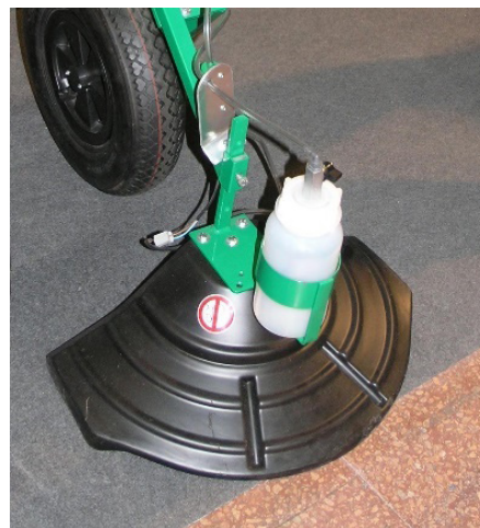
6.11 Particolare del gruppo irrorante (con ugello centrifugo) per il diserbo localizzato essere telecomandato
