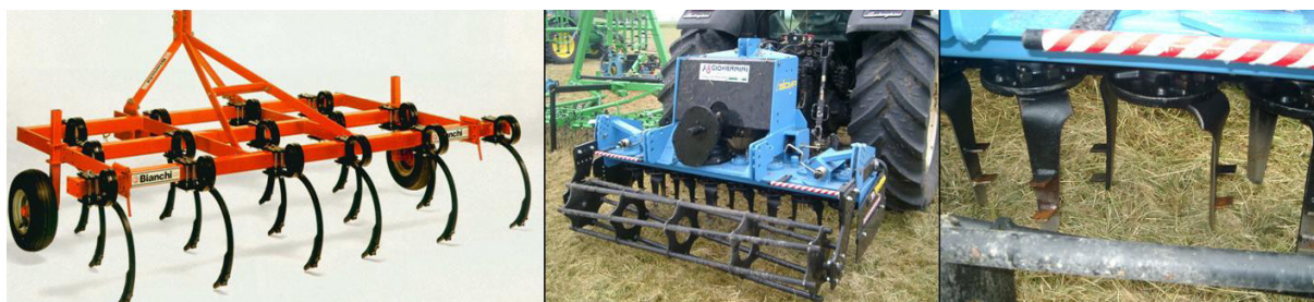
2.16 Erpice a denti a molla, disposti su più ranghi (a sx); erpice rotativo e particolare delle lame GB (a dx)
