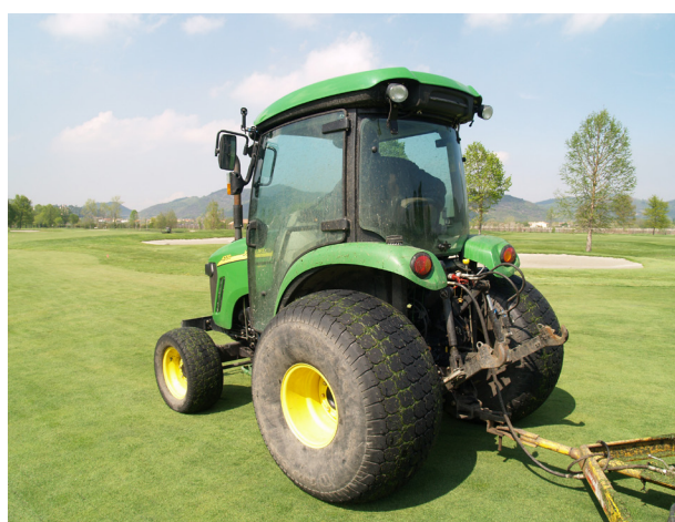
1.3 Trattorino polivalente con cabina: vista posteriore con in evidenza l'attacco a tre punti
