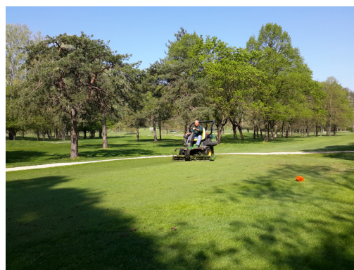
5.16 Rider a tre cilindri con lame elicoidali adatta al taglio dell'erba nei tee
