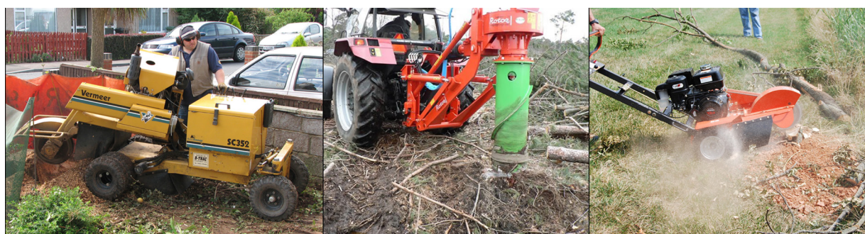
2.2 Macchine per la rimozione delle ceppaie. Macinaceppi con fresa semovente con operatore a terra (a sx); cavaceppi portata da trattore (al centro); macinaceppi con fresa con conducente a terra (a dx)
