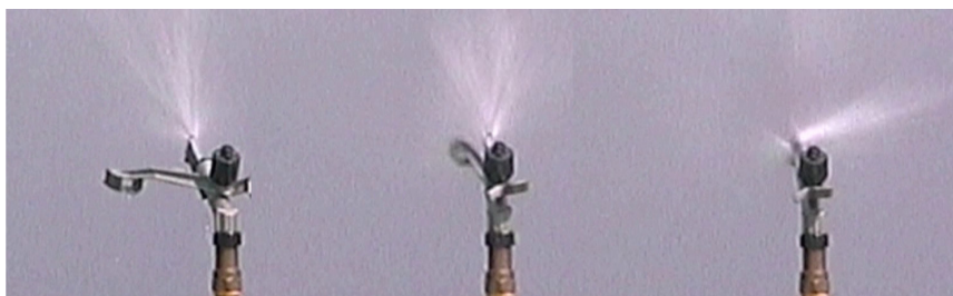
7.6 Funzionamento di un irrigatore dinamico a deflettore oscillante (martelletto)
