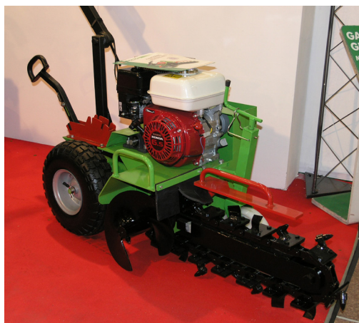
2.10 Attrezzatura con conducente a terra e organo lavorante a catena
