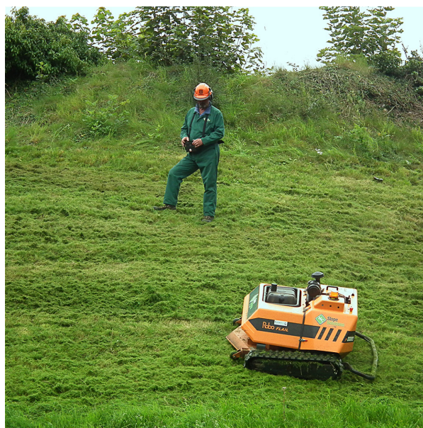
4.7 Rasaerba telecomandato impiegato per la manutenzione di una sponda fluviale
