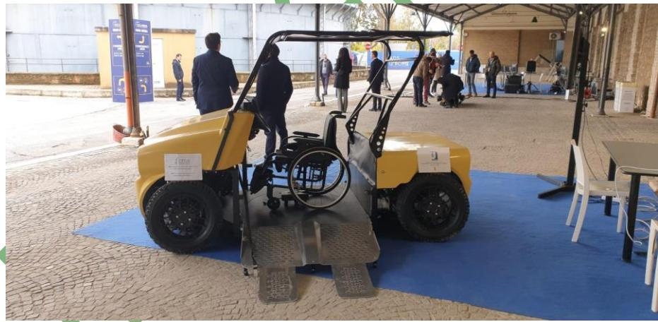
Libera 2 assicura, inoltre, standard di protezione contro il rischio di ribaltamento, garantiti da un opportuno dimensionamento di carreggiata e baricentro, e dispone di quattro ruote motrici sterzanti, sospensioni pneumatiche, sistema di guida con comandi manuali al volante per il completo controllo della trazione, acceleratore wireless e tettino fotovoltaico. L'innovativo sistema di pedane laterali, con apertura e
